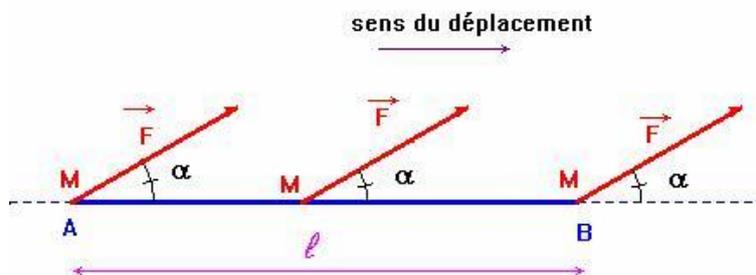
Calculer le travail de la force  $\vec{F}$  sachant que :  $F = 10 \text{ N}$ ,  $l = 7,70 \text{ cm}$  et  $\alpha = 30^\circ$ .
