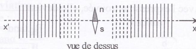
En absence du courant électrique dans le solénoïde, l'aiguille prend une position horizontale perpendiculaire à  $x'x$ , l'axe du solénoïde (voir la figure).
