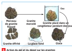
b Action du gel et du dégel sur les granites
