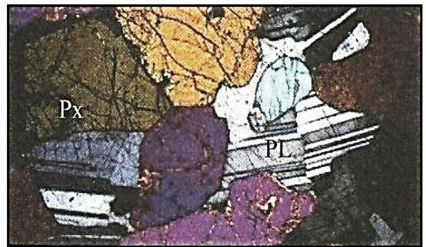
d- Lame mince de gabbro observée au microscope polarisant (Px: pyroxènes; Pl: plagioclases)
