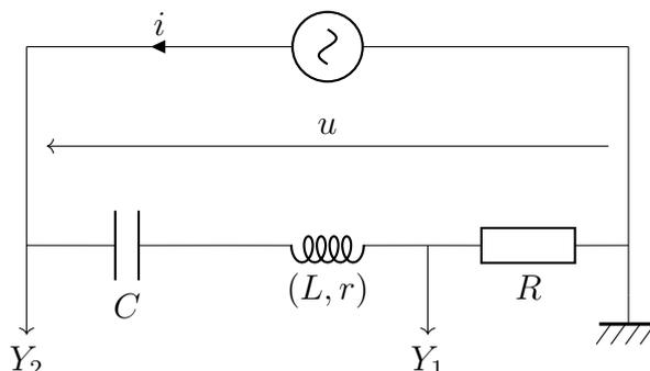
On visualise sur l'oscilloscope connecté au circuit les courbes l'une du conducteur ohmique et la deuxième du circuit (RLC).
