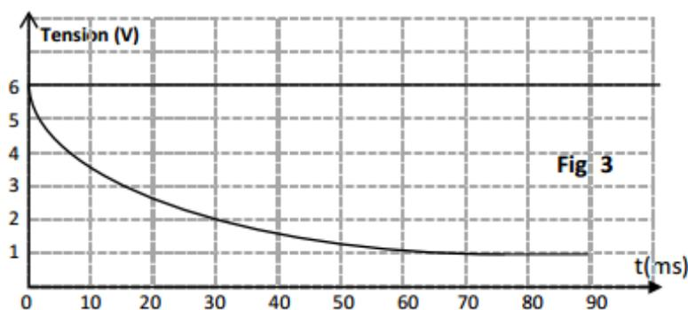
a. Montrer qu'en régime permanent, la tension aux bornes de la bobine ( $B_2$ ) est :  $U_{B2} = \frac{rE}{r+R}$
