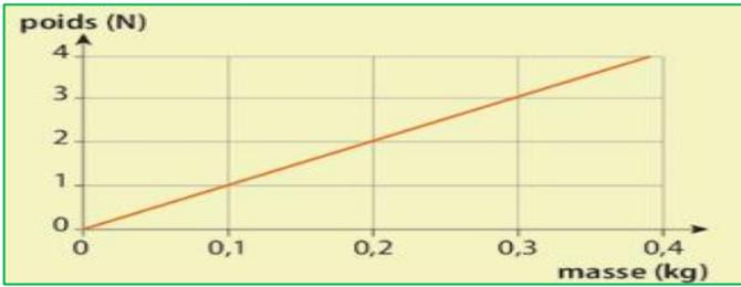
1. Déterminer l'intensité de poids P de masse  $m=200$  g .
