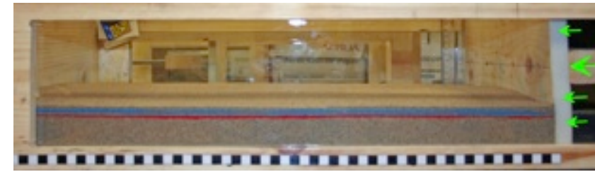
La «boîte à sable» qui représente le déclenchement des séismes. Les «roches» (sable) vont être comprimées par des forces (flèches vertes)
