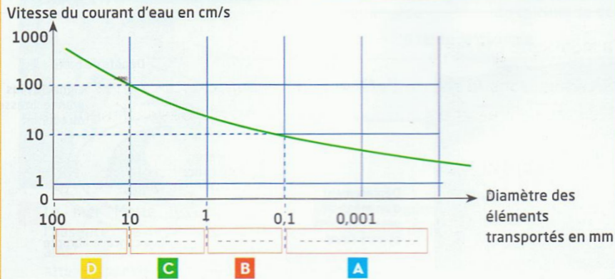
Diamètre des éléments transportés en fonction de la vitesse du courant
